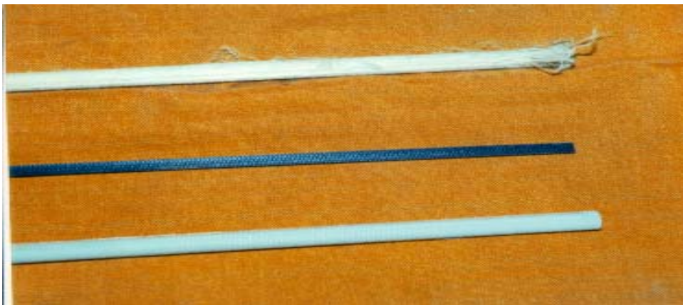
Slika 3. FRP Armature: (odozgo) aramidска, karbonatna i staklena šipka i staklena FRP uzengija
