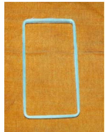
Slika 3. FRP Armature: (odozgo) aramidска, karbonatna i staklena šipka i staklena FRP uzengija
